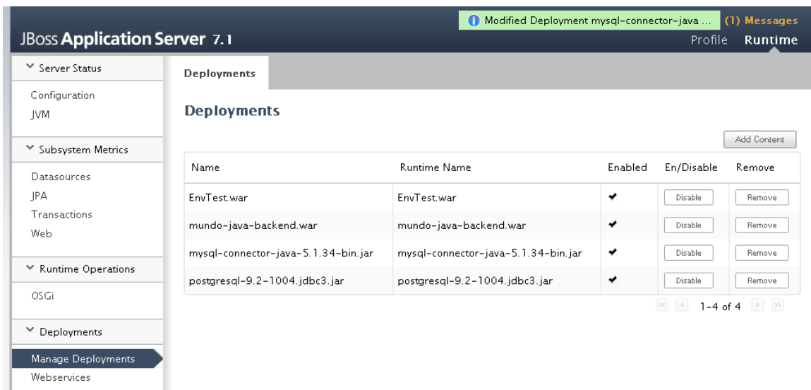
Rysunek 47 Konfiguracja sterownika JDBC
