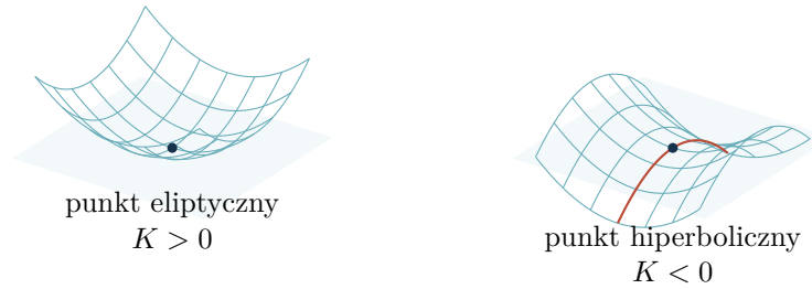
Rysunek 5: Lokalne modele drugiego rzędu. Jasne płaszczyzny są styczne w wyróżnionych punktach. W przypadku siodła powierzchnia przechodzi na obie strony swojej płaszczyzny stycznej.
